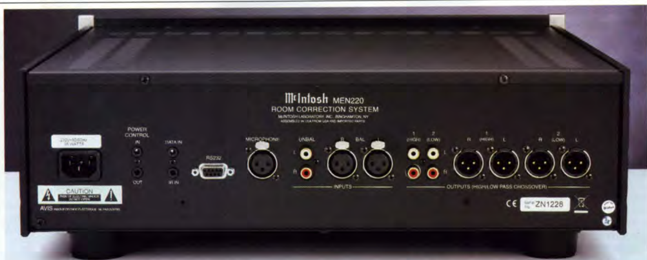
Sul pannello posteriore sono visibili, a partire da destra, le due uscite stereo bilanciate e sbilanciate, utilizzabili anche come uscite del filtro passa-basso e passa-alto del crossover incorporato, gli ingressi bilanciati e sbilanciati, l'ingresso bilanciato per il microfono, la porta RS-232C (utilizzabile per gli aggiornamenti del firmware) e vari jack per segnali di controllo.
